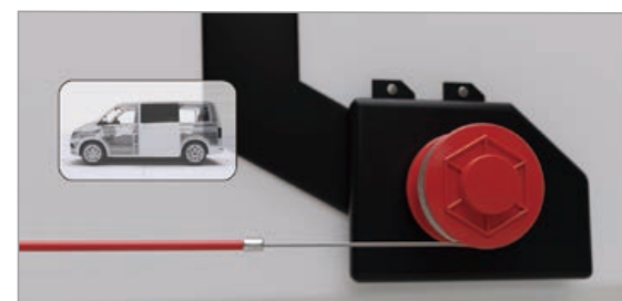
自動車 (スライドドアの開閉機構)
